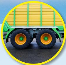
Doble eje (modelos 480 y 540) o triple eje (modelos 540 y 590)
