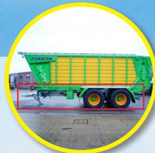
El bastidor, la estructura y las chapas de fondo están galvanizados para garantizar una larga vida útil
