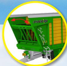
La pared frontal inclinada garantiza una distribución ideal de la carga y mejora la descarga
